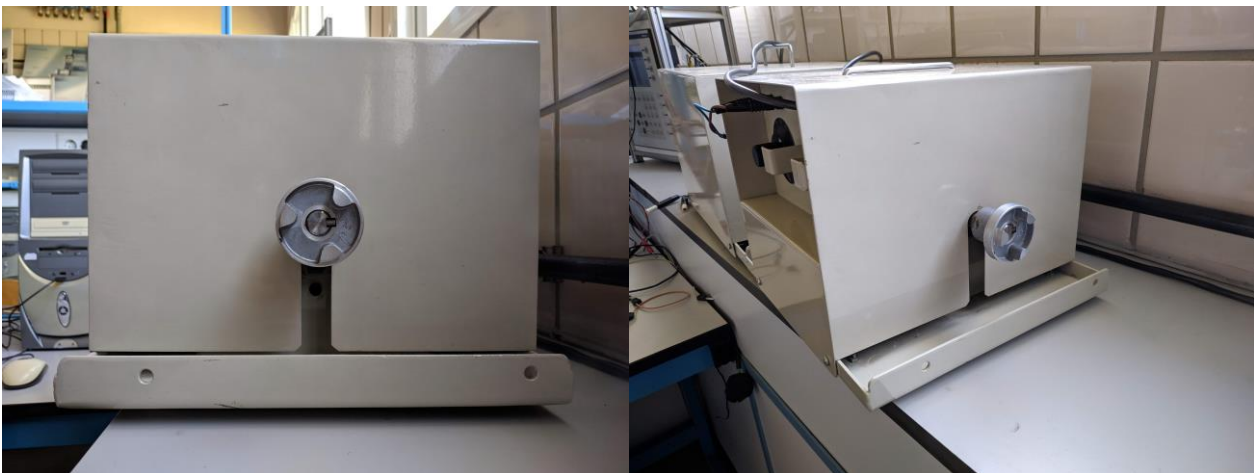
9 Vista del eje previa al montaje del sensor
