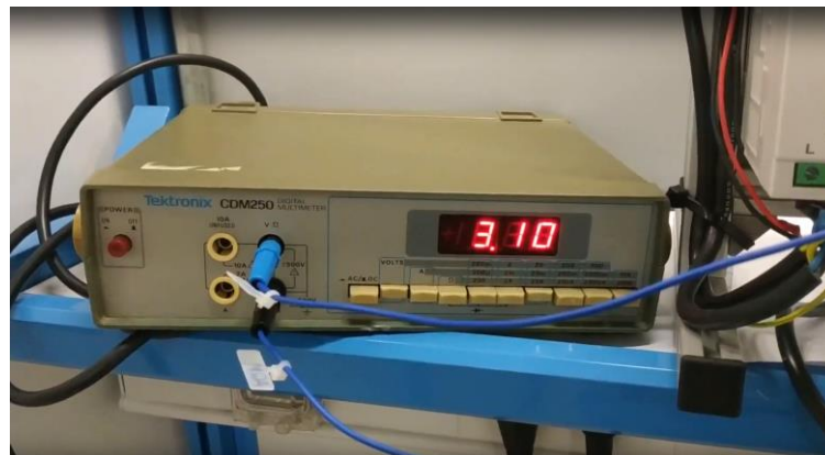
13 Conexión del multímetro a la salida analógica del autómeta
