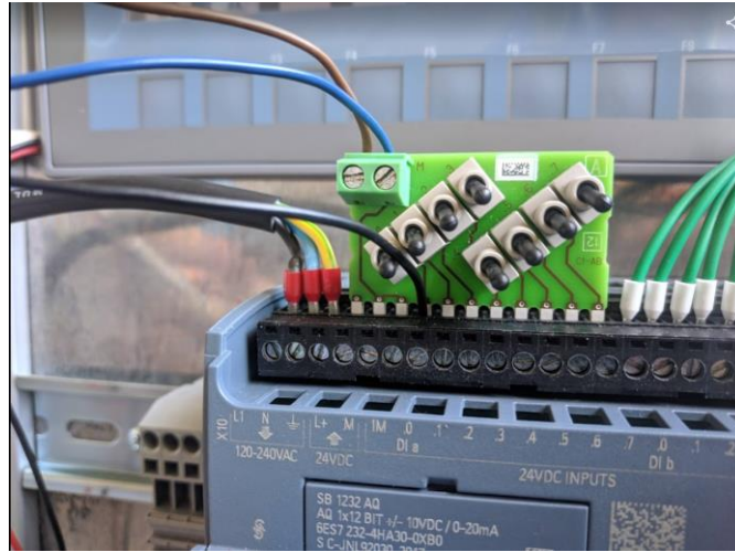
16 Conexión sensor inductivo a S7-1200
