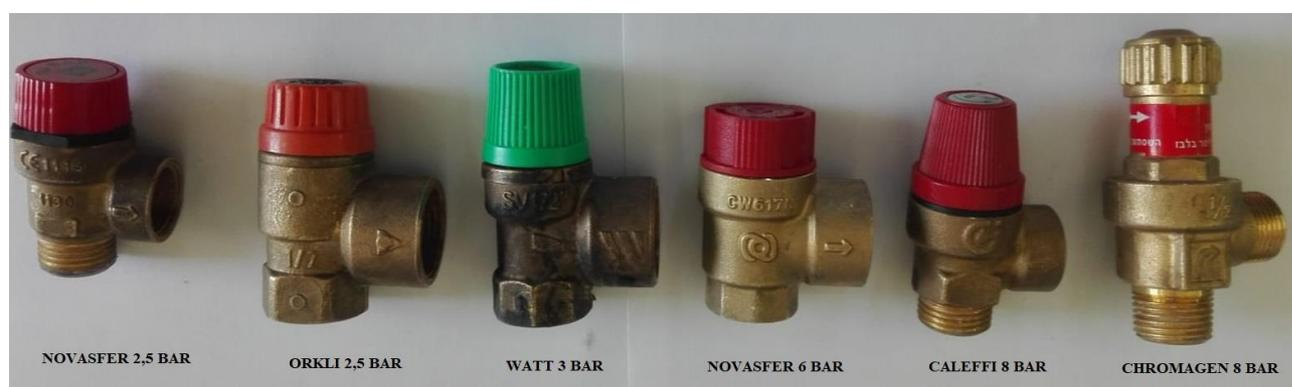
Figura 12. Conjunto de válvulas ensayadas vistas de perfil.
