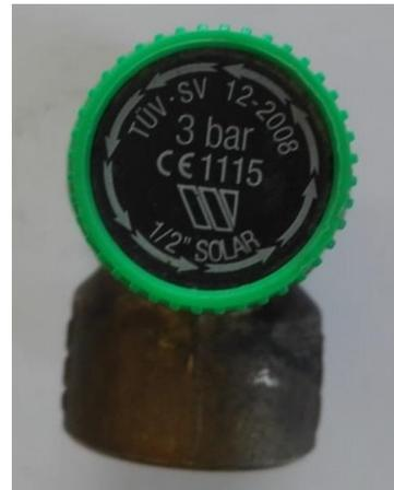
*Figura 7. Imagen de la válvula Watt 3 bar.*
