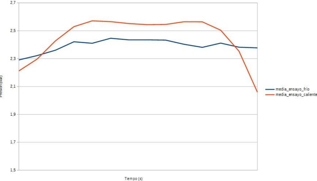
Figura 60. Comparación media de ensayos válvula Orkli 2,5 bar. Media de valores medidos cada 10 segundos.
