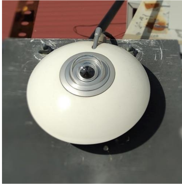
Ilustración 3-1: Piranómetro instalado en la estación meteorológica de la ETSI de Sevilla. Fuente: http://estacionmeteo.us.gter.es/
