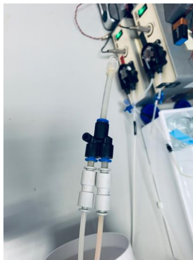
Figura 18. Unión de conductos DMSO y PBS en forma de "T".
