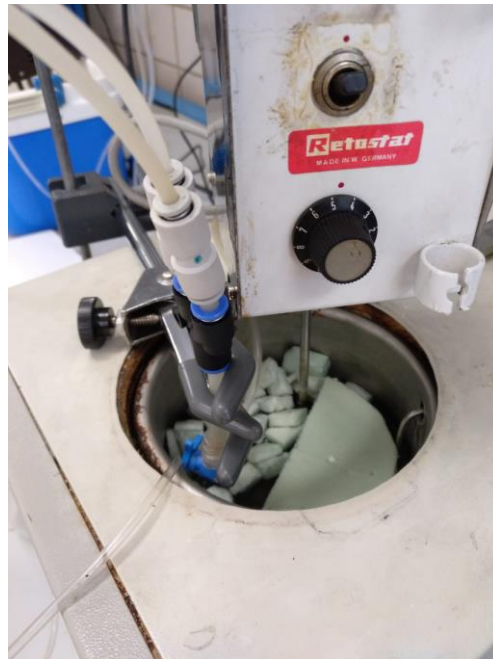
Figura 40. El criotubo con el corazón debe estar completamente sumergido.
