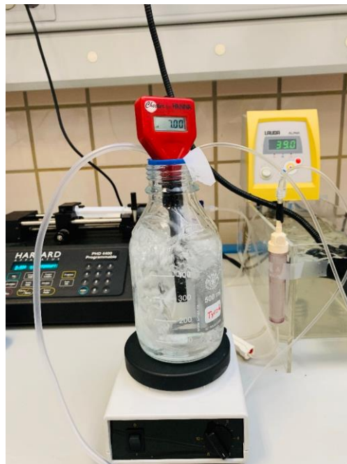
Figura 10. Medición de pH a solución Tyrodes oxigenada.
