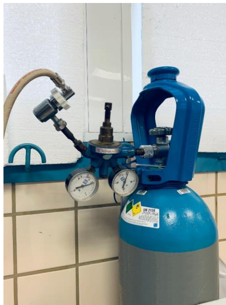
Figura 9. Carbógeno. Válvula completamente cerrada.
