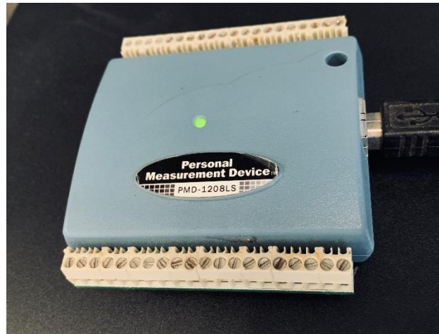
Figura 22. Tarjeta de adquisición de datos conectada a PC por USB
