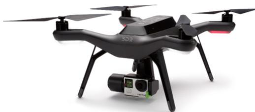
Figura 1.1 Plataforma inercial con una cámara instalada en un dron [2].
