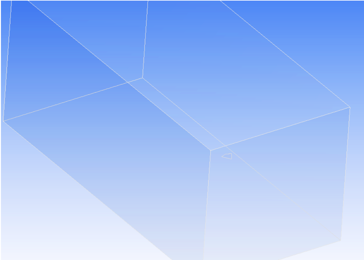
Figura 5-13. Volumen de control de la cola para la simulación en Fluent.
