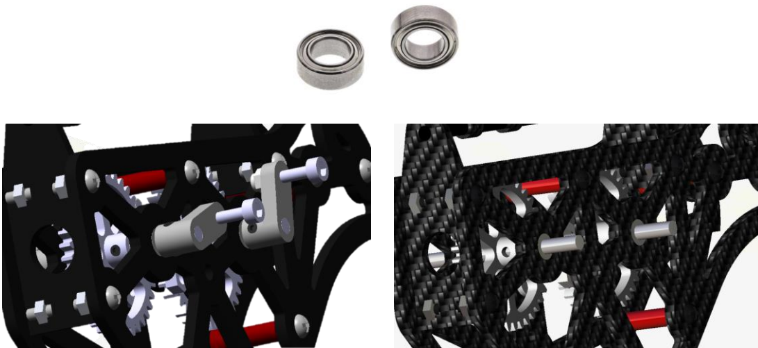
Figura 3-17. Rodamientos y su configuración en el prototipo.
