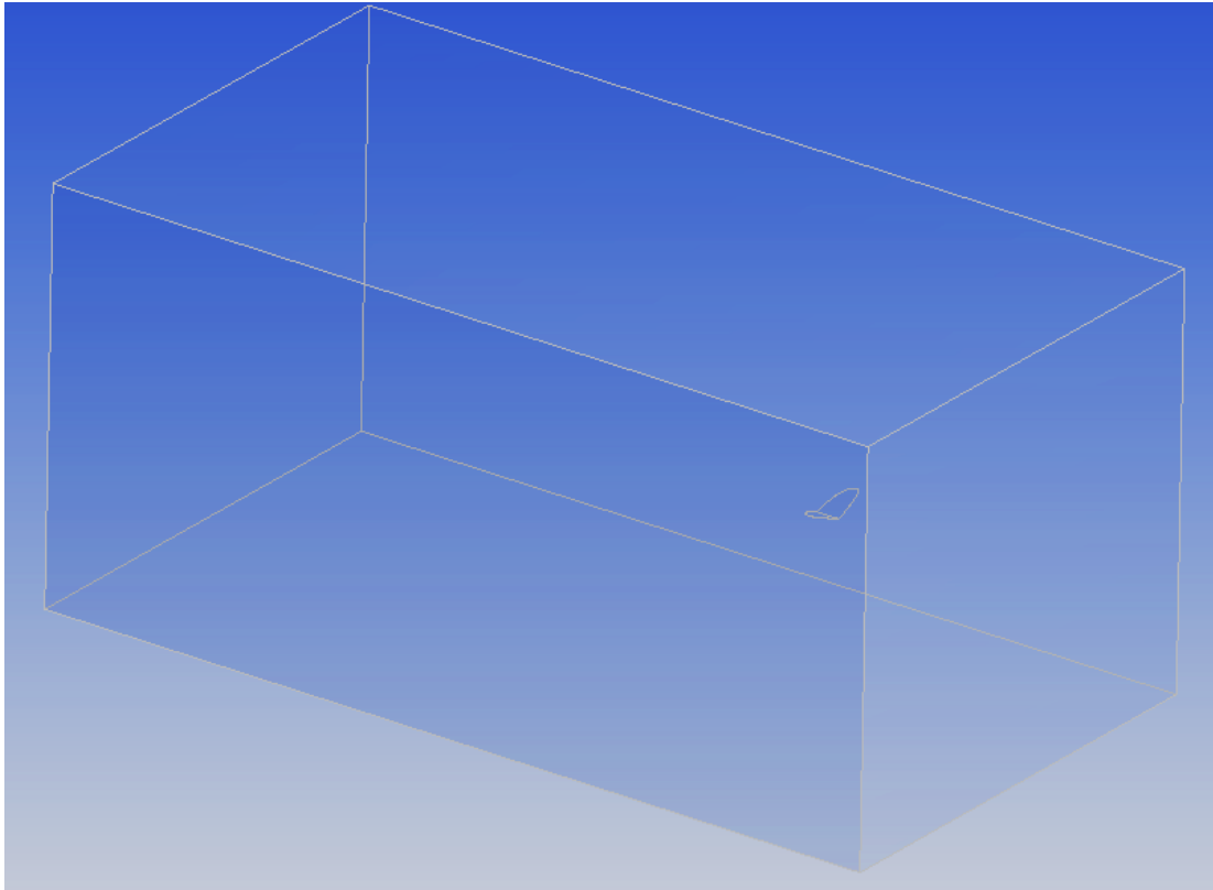
Figura 5-6. Volumen de control – Túnel de viento de la simulación en Fluent del ala.
