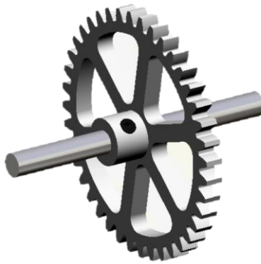
Figura 3-16. Agarre Engranajes 3 y 4 al eje de giro
