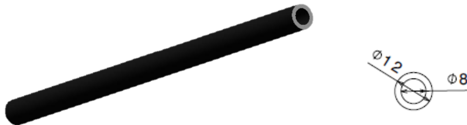
Figura 3-9. Tubo de fibra de carbono [mm].
