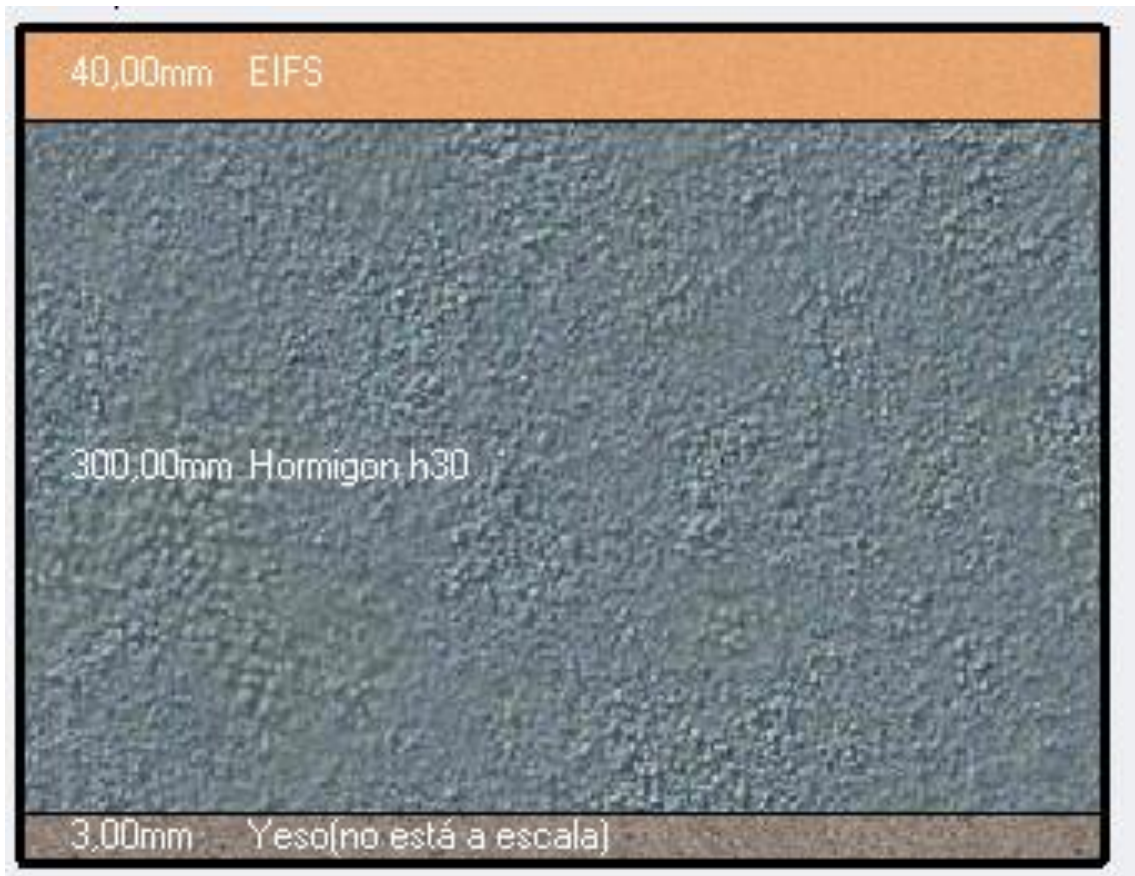
Imagen nº23: Muro exterior. Fuente: Elaboración propia Design Builder
