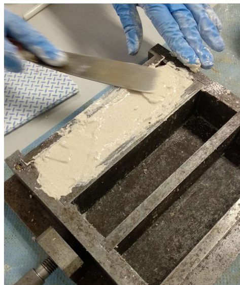
Figuras 11 y 12: vertido de masa y conformación de probeta mecánica.
