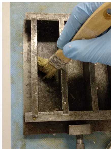
Figuras 8: aplicación de desencofrante al molde.
