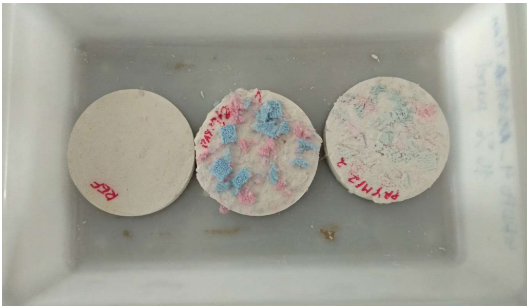
Figura 17: probetas para ensayo de absorción acústica.
