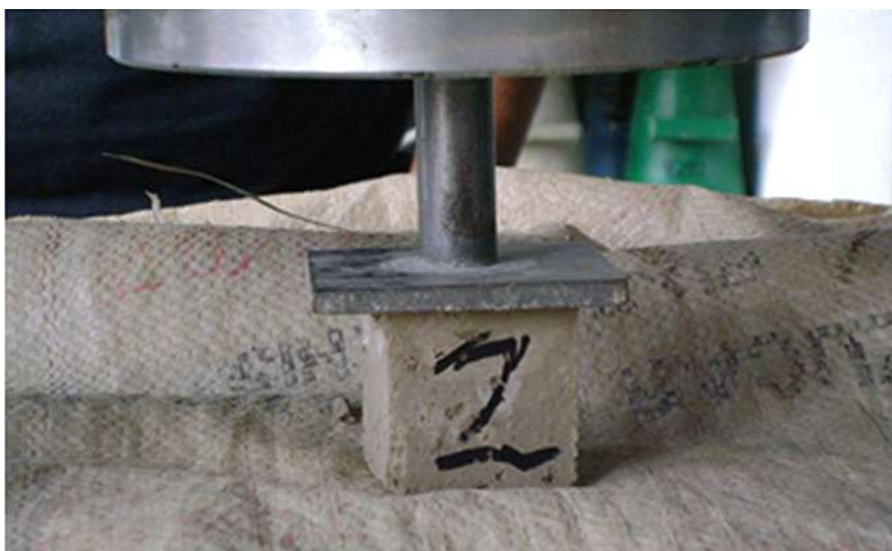
Figura 16: ejemplo de ensayo de resistencia a compresión. (Ovando de la Cruz y Ruíz Castellanos, 2010)
