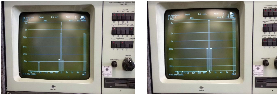
Figuras 20 y 21: ejemplo de medición de presión mínima (izquierda) y máxima (derecha) a 1000 Hz para la muestra PAYM/2-1.
