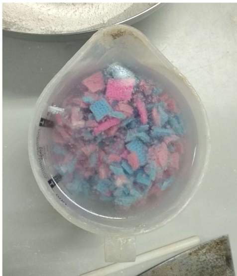
Figuras 9 y 10: mezcla previa microfibra-agua y obtención de masa de yeso.
