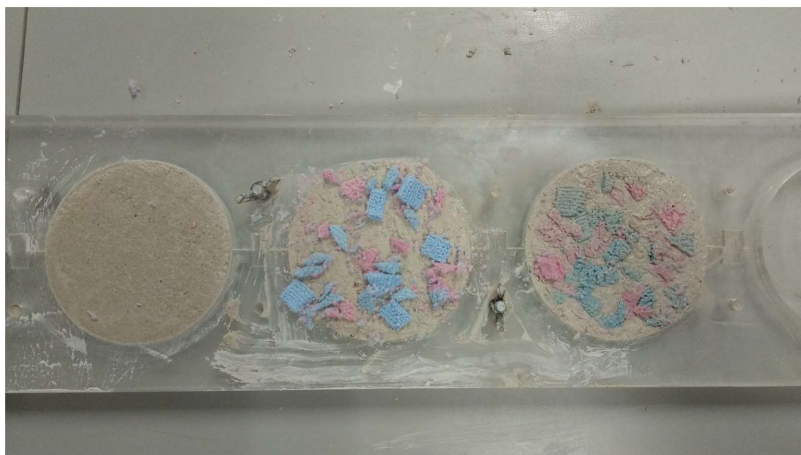
Figura 13: probetas para ensayo acústico ya fabricadas.
