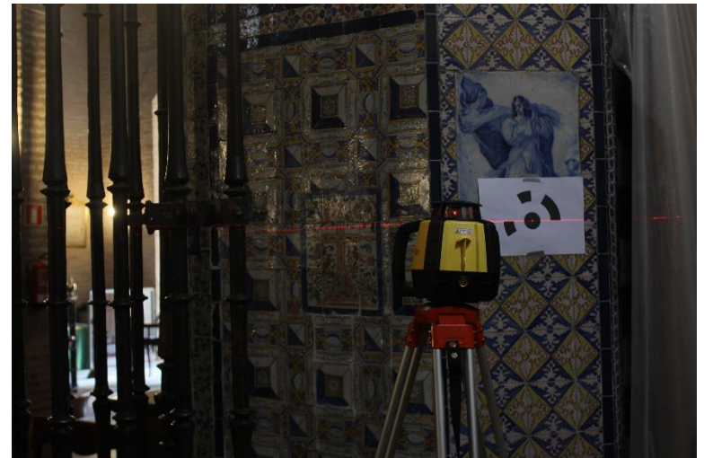
Figura 6-3 Proceso de colocación de las dianas
