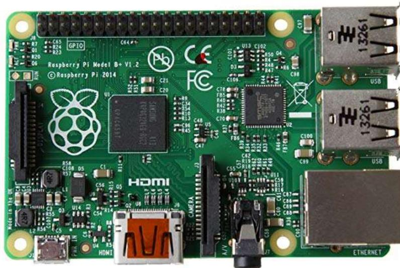
Ilustración 3:Raspberry Pi Model B+
