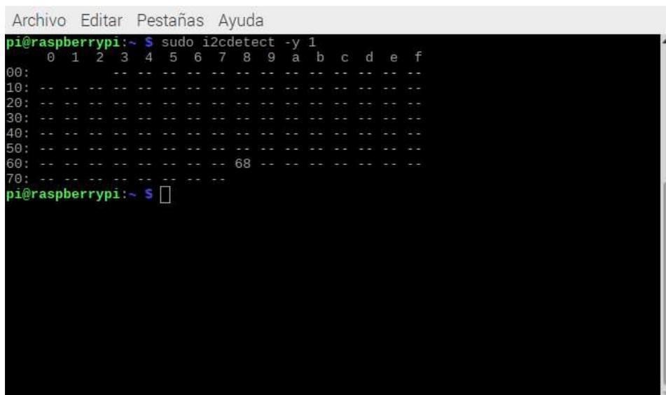
Ilustración 56: MPU-6050 – Puerto I2C
