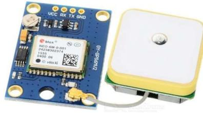
Ilustración 6: Sensor u-blox NEO-6M-0-001
