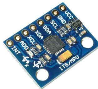
Ilustración 5: Sensor MPU-6050
