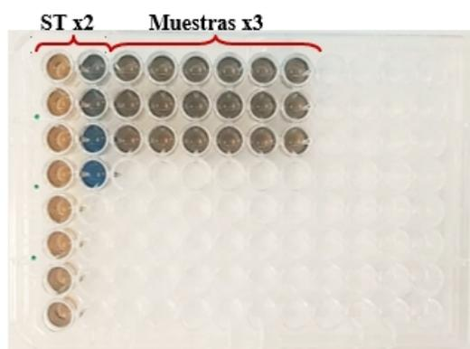
**Figura 6. Microplaca Elisa de 96 pocillos cargada para la determinación de la concentración de proteínas.**
