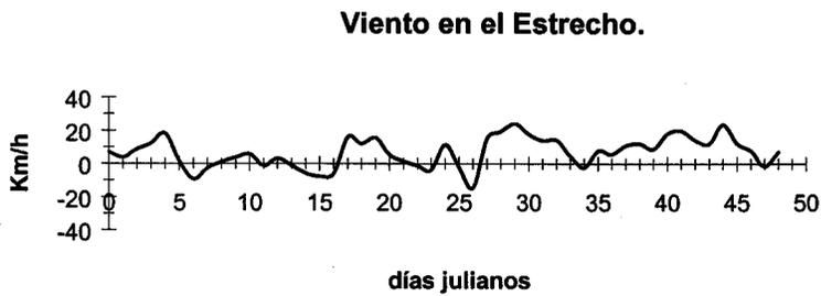
Figura 3-9. Componente Este-Oeste del viento medida en Ceuta y expresada en km/h. Los valores positivos coinciden con los vientos de poniente
