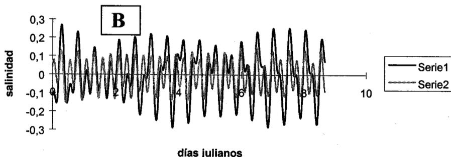
Figura 3-23. Velocidad normal a costa ( figura A ) y salinidad ( figura B ) en los correntómetros 1 y 2 ( series 1 y 2 respectivamente ). La salinidad representa desviaciones respecto al valor medio expresadas en la escala práctica de salinidades mientras que la velocidad se expresa en cm/s.
