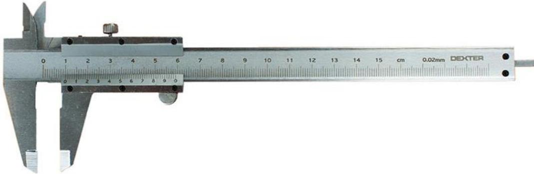
**Figura 5. Calibre de medición.**
