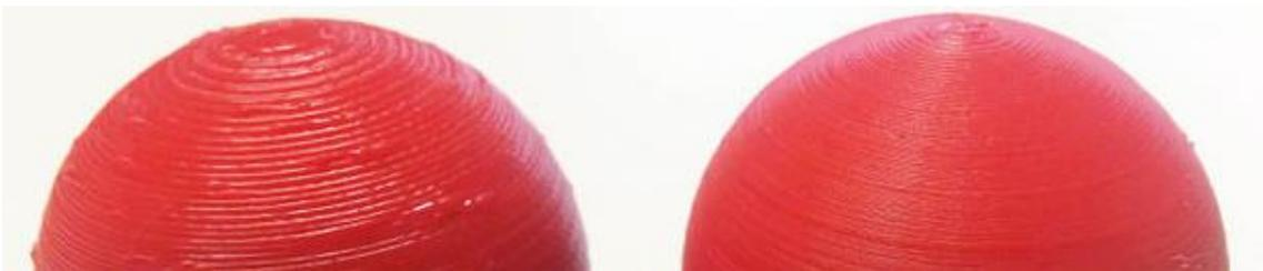
**Figura 215. Diferencia entre alturas de capa.**
