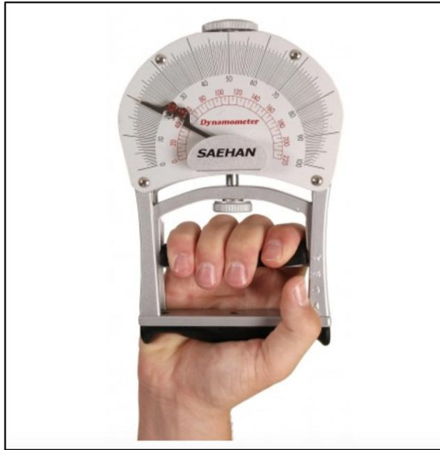
Figura 5. Dinamómetro de mano para la medición de la fuerza de agarre.
