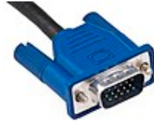
VGA: transporta video RGB e información de sincronización vertical y horizontal (f)
