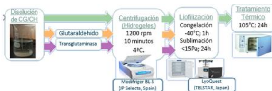
Figura 23: Esquema del procesado de andamios llevado a cabo con los distintos métodos de entrecruzamiento
