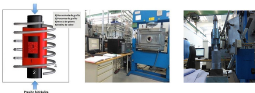
Figura 2. Esquema e imagen del equipo de compactación en caliente (iHP).
