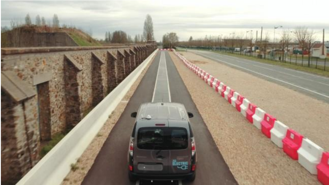
Figura 11.11.2.1 carril de recarga eléctrica inalámbrica ( https://elpais.com/tecnologia/2017/05/31/actualidad/1496240563_991528.html )
