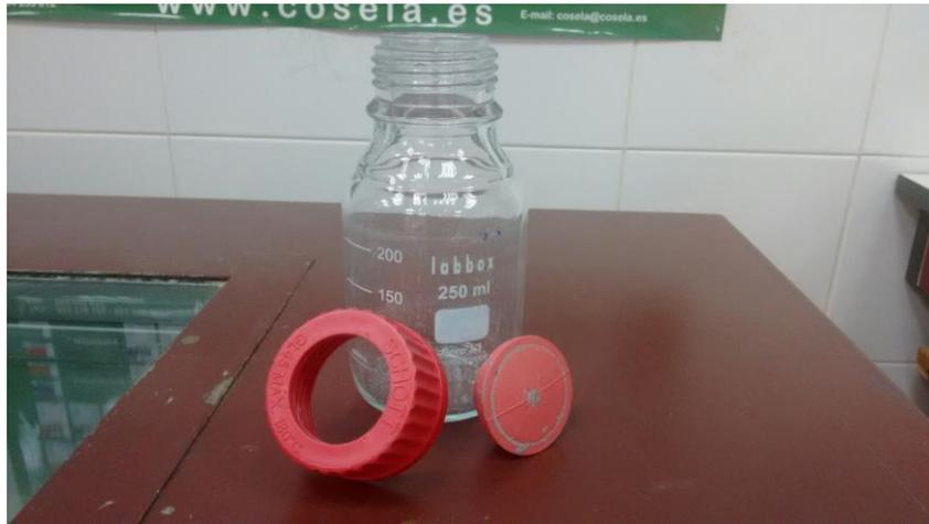
Figura 2.1 Imagen correspondiente a un microdigestor y los tapones utilizados para su cierre hermético (Alonso,2017)
