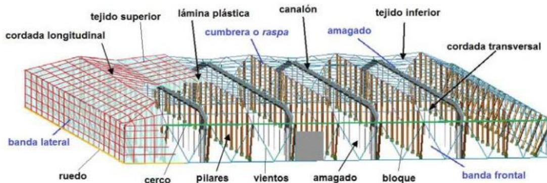
Figura 5: Estructura de un invernadero parral plano. (Fuente: Valera et al., 2014)
