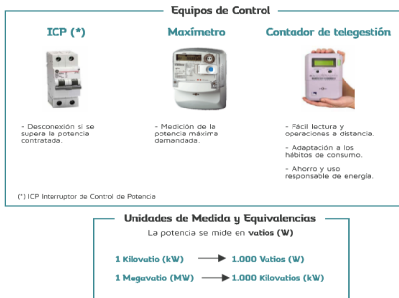
Figura 3.4. Equipos y unidades de medida de la potencia Fuente: Dossier presentación de producto Lúmina Energía 2017
