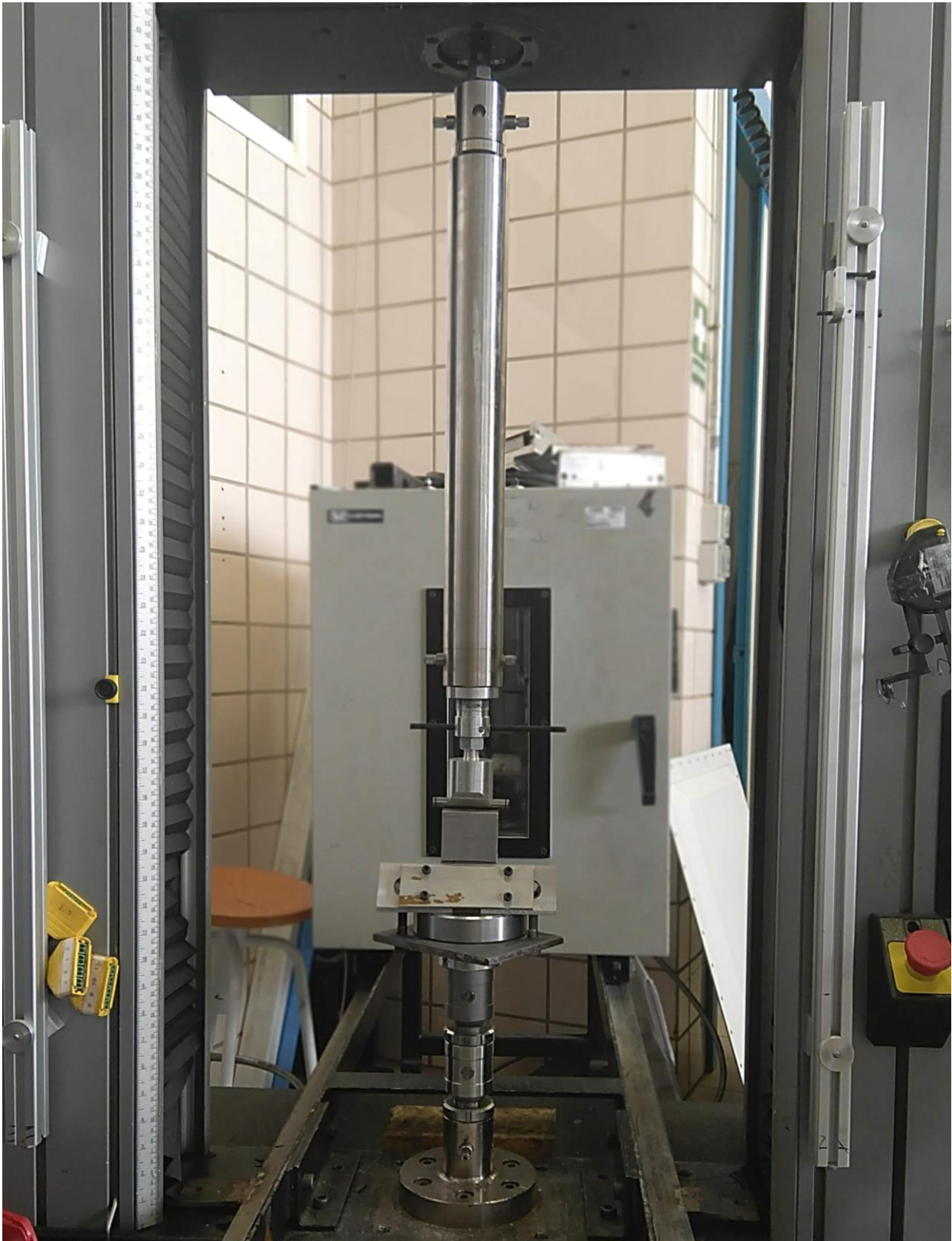
Figura 3.7. Disposición usada en los primeros ensayos con el acople cilíndrico largo.
