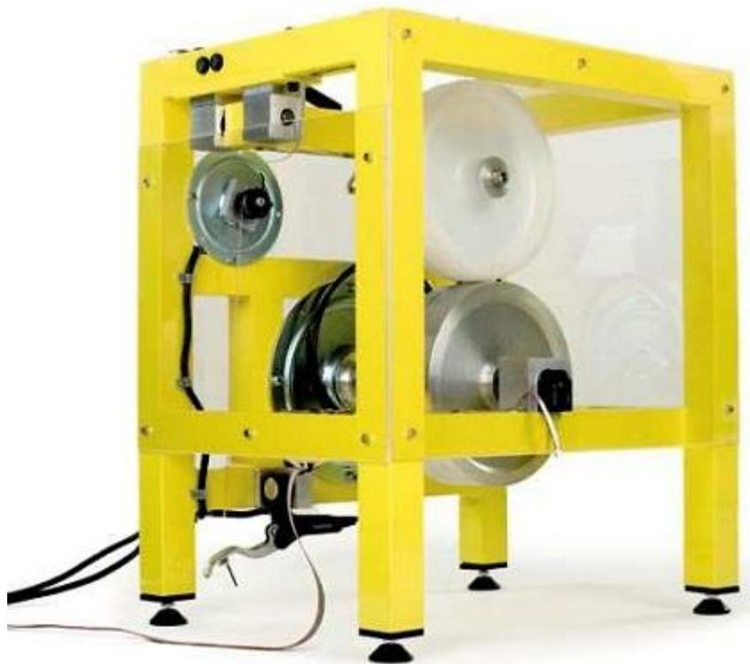
Figura 3.1. Prototipo del sistema ABS de un coche.
