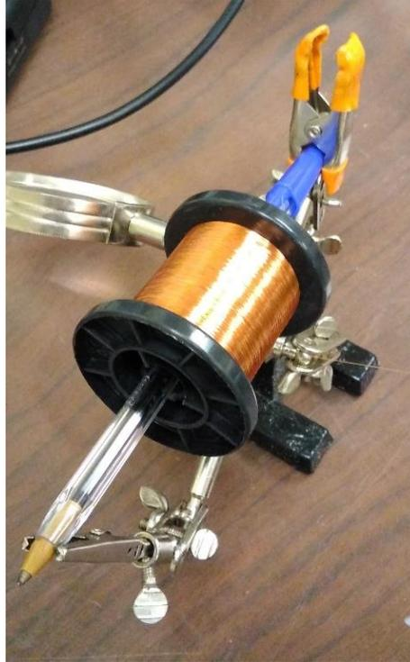
Figura 4-5 Montaje del soporte para la bobina de cable para arrollamientos
