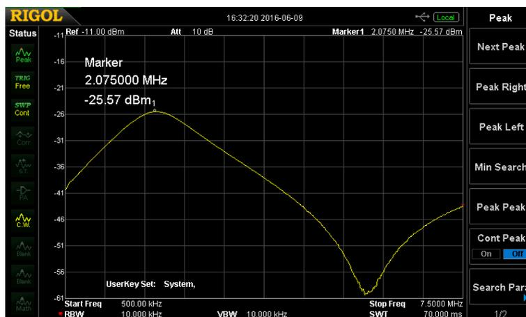
Figura 3-25 Resonancia con  $C_{ext}$  de 10 nF para determinar  $L_{lk1}$
