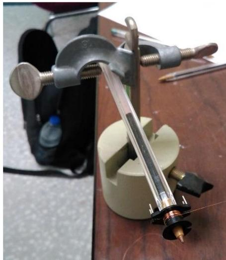
Figura 4-6 Montaje del soporte para los cuerpos de los transformadores
