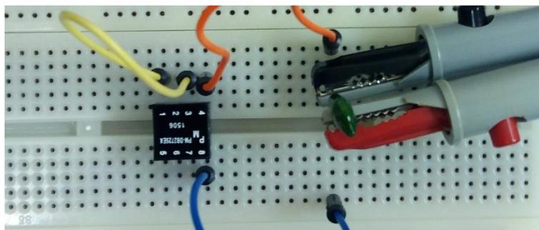
Figura 3-30 Montaje  $C_{ext}$  de 10,3 nF para la medición  $L_{lk2}$
