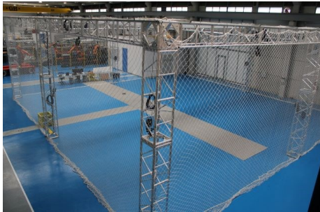
a) Indoor flight cage for UAVs (CATEC Centro Avanzado de Tecnologías Aeroespaciales, Sevilla)
