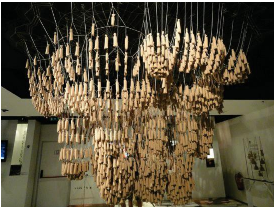
Figura 20: Maqueta funicular de Gaudí expuesta en el Centre Reus (Tarragona)
