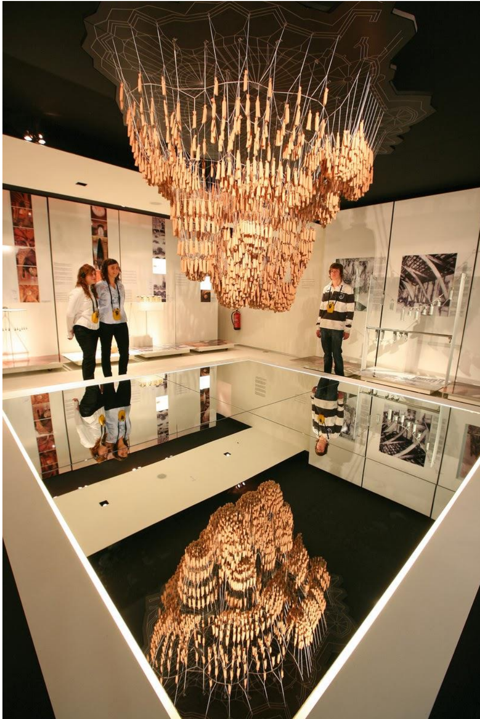
Figura 21: Maqueta funicular de la Sagrada Familia. Gracias al reflejo del espejo tenemos el resultado de lo que sería una estructura que, manteniendo una orientación vertical, resulta apta para la construcción.
