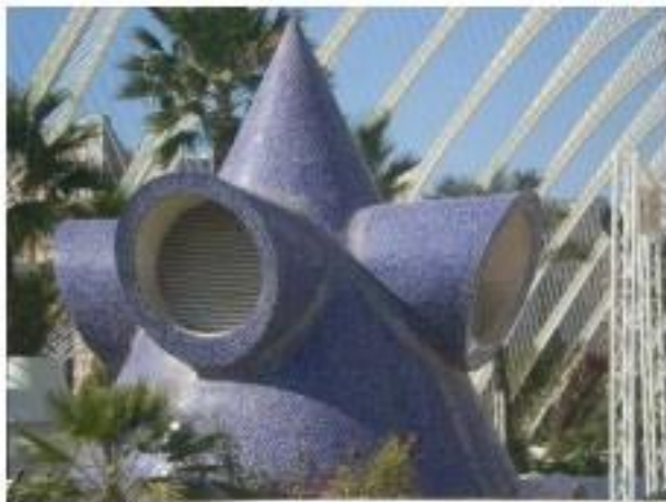
Figura 78: Elemento de ventilación de la Ciudad de las Ciencias y las Artes formado por la intersección de un cono y dos cilindros.
