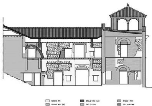
Figura 2 Resultado por cronologías de uno de los muros principales de la casa Palacio de Segovias 1, Sevilla. Planimetría de D. Luís Núñez Arce
