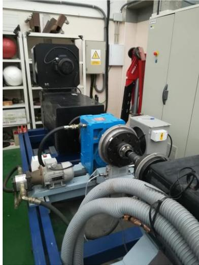
Figura 3. Banco de ensayos (Torsímetro de salida, reductora adicional y freno motor)
