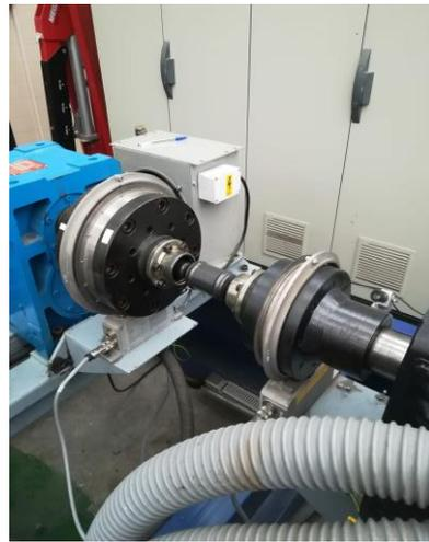
Figura 4. Banco de ensayos (Torsímetro de salida)
