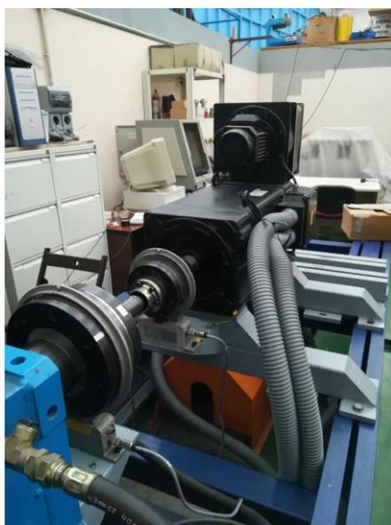
Figura 2. Banco de ensayos (Motor eléctrico y torsímetro de entrada)
