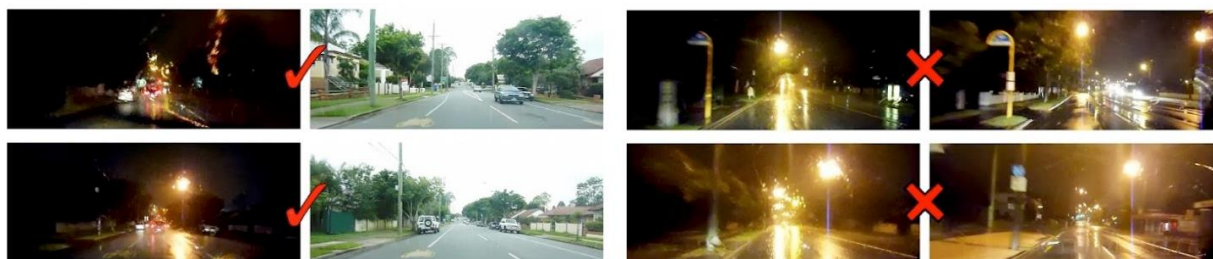
Figura 2.1 – Condiciones cambiantes, izquierda. Fenómeno de aliasing perceptual, derecha.
