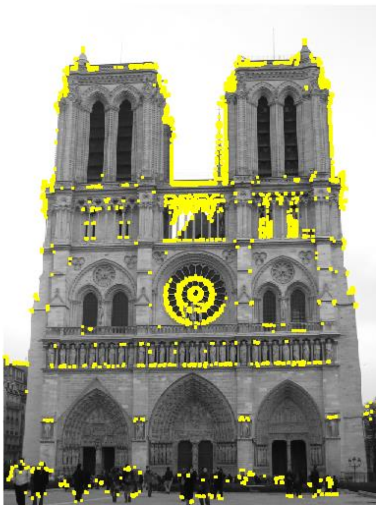
Figura 2.4 – Detector de esquinas de Harris.
