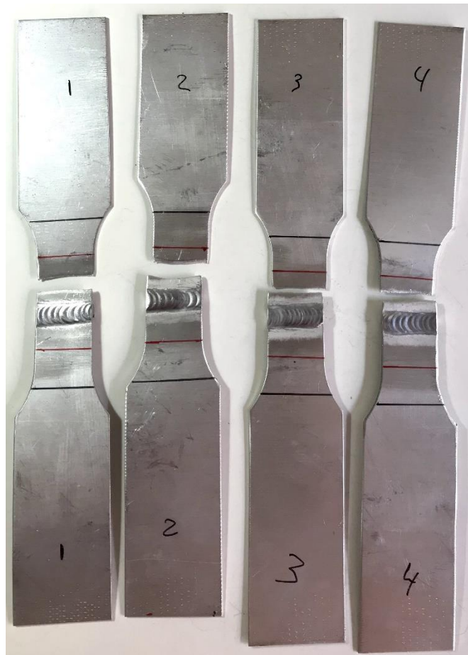
Soldadura con previa solubilización + maduración con 1 reparación
