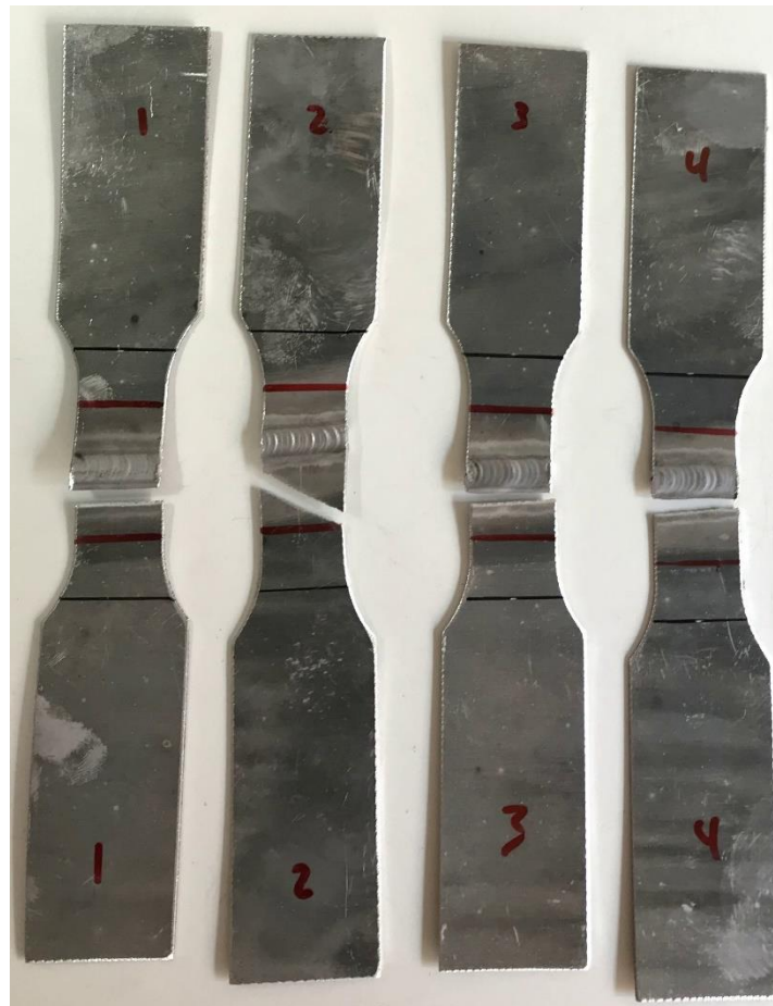
Soldadura con posterior solubilización + maduración con 1 reparación
