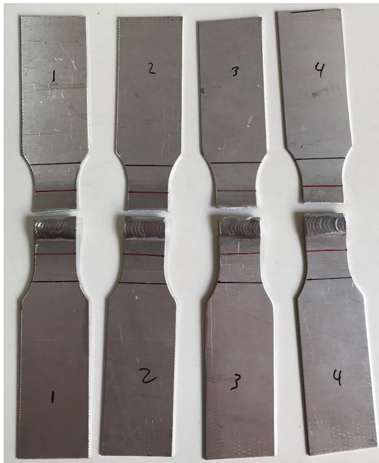
Soldadura con posterior maduración con 3 reparaciones
