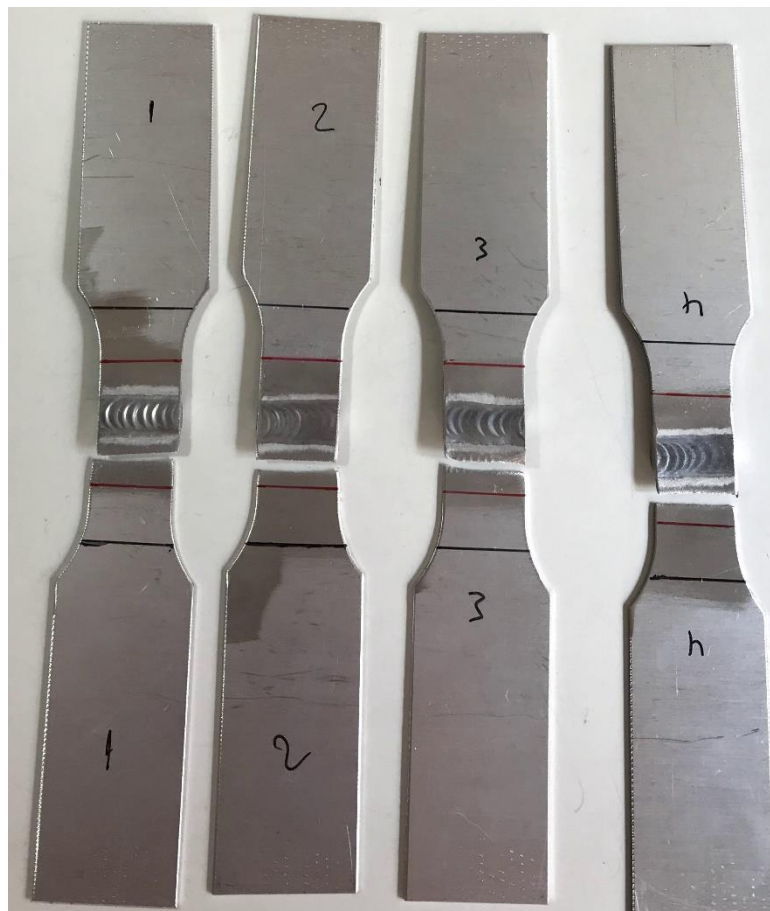
Soldadura con previa maduración con 3 reparaciones
