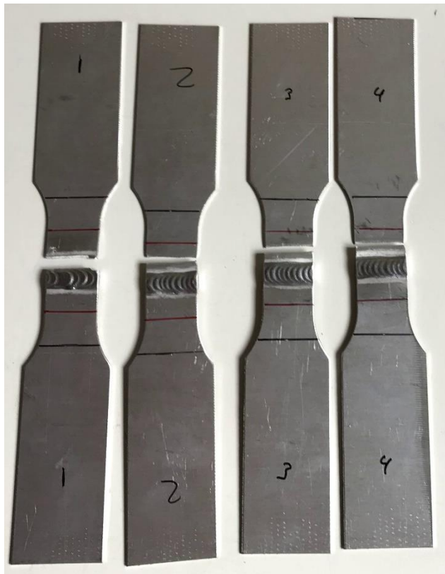
Soldadura con posterior maduración con 1 reparación
