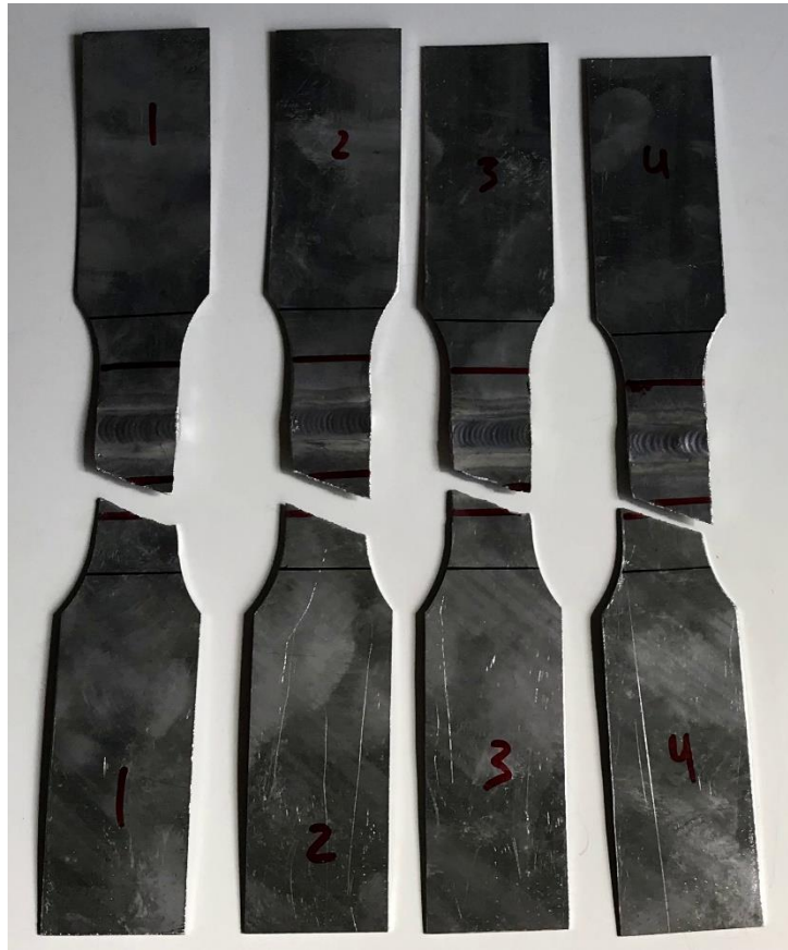
Soldadura con posterior solubilización + maduración con 3 reparaciones
