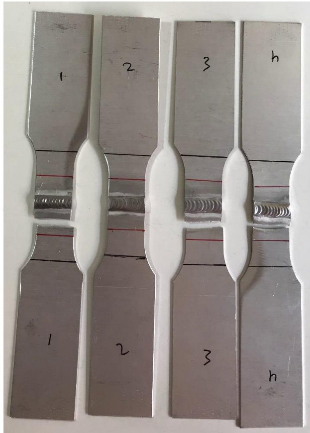
Soldadura con posterior maduración con 1 reparación
