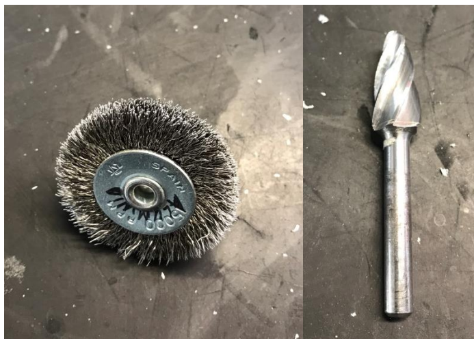
Figura 10. Herramientas utilizadas para el proceso de conformado durante las operaciones de reparación. Cepillo de alambre (izquierda), fresa (derecha).
