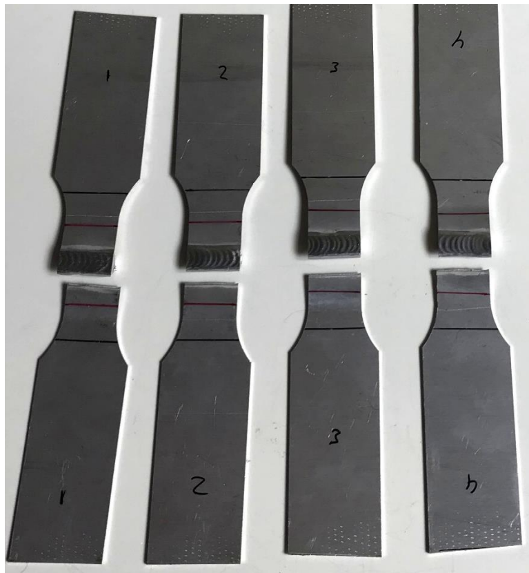
Soldadura con posterior maduración con 3 reparaciones
