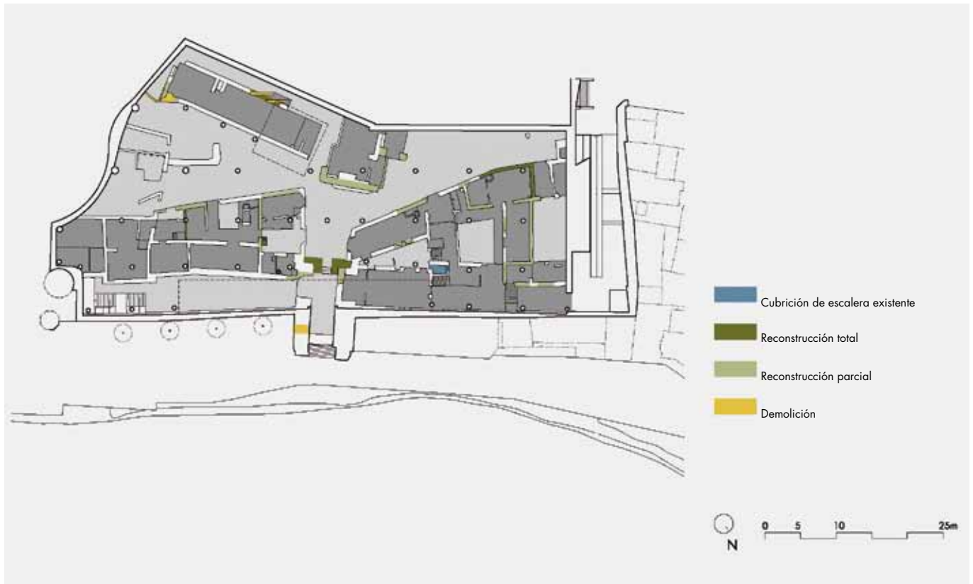
Actuaciones sobre los restos. Planta. Plano: virillosarquitectos
