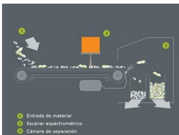
Figura 3-4. Funcionamiento de un separador óptico.
