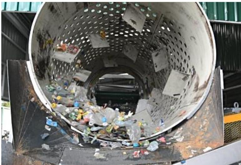
Figura 3-2. Vista frontal de un trommel en funcionamiento para la separación granulométrica.
