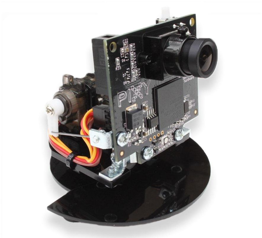
Figura 3-1. Sensor Pixy instalado con los servomotores y los apoyos
