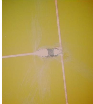
Figura 6.9 – Detalle de soldadura de NTC bajo microscopio
