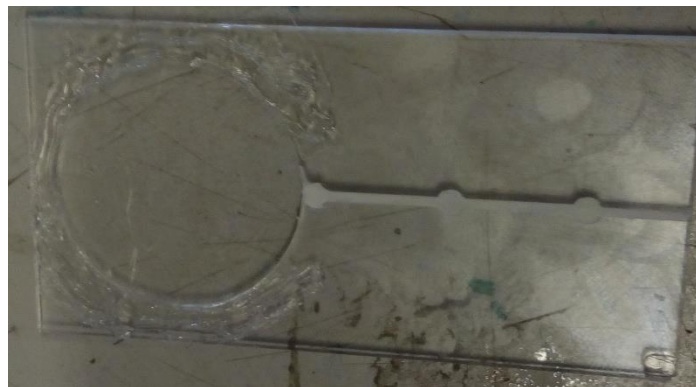
Figura 6.15 – Canal inundado con plastilina blanca, para evitar la deposición del pegamento en su interior, y pegamento termofusible aplicado parcialmente
