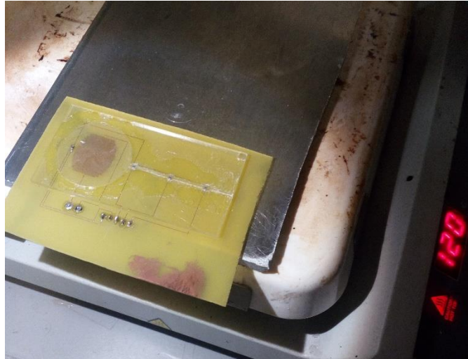
Figura 6.16 – Pegado de PMMA con PCB usando pegamento termofusible
