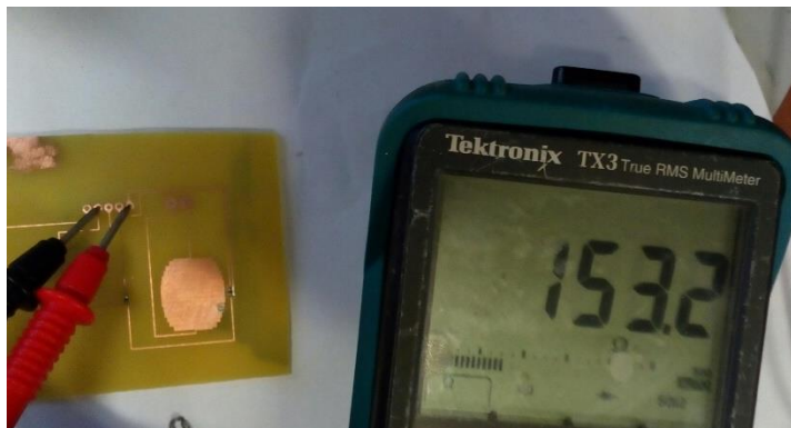
Figura 6.10 – Medición de valor resistivo de NTC
