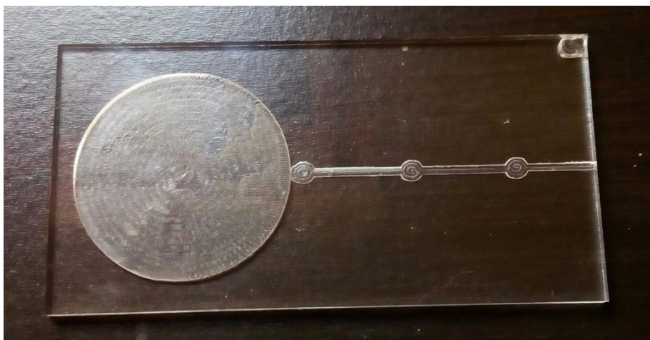
Figura 6.13 – Circuito microfluídico fresado en PMMA sobre fondo marrón
