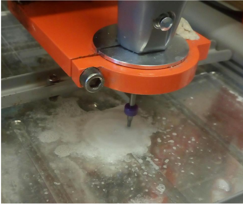
Figura 6.12 – Fresado de circuito microfluídico en PMMA
