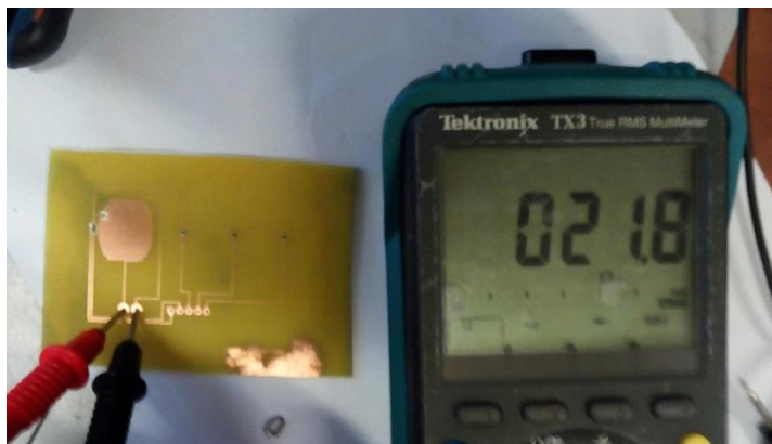
Figura 6.11 – Medición de valor resistivo del calentador
