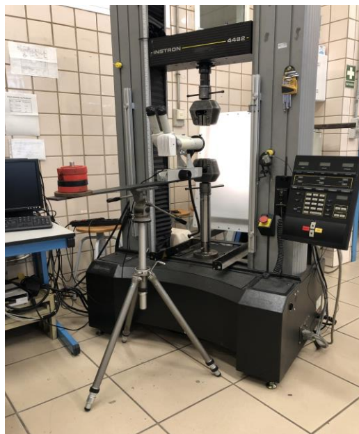
Figura 4.9.- Trípode preparado con la lupa acoplada frente a la máquina de tracción disponible en el laboratorio.
