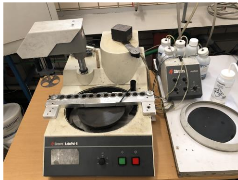
Figura 4.4.- Máquina de lijado y pulido juntos a las soluciones a utilizar.
