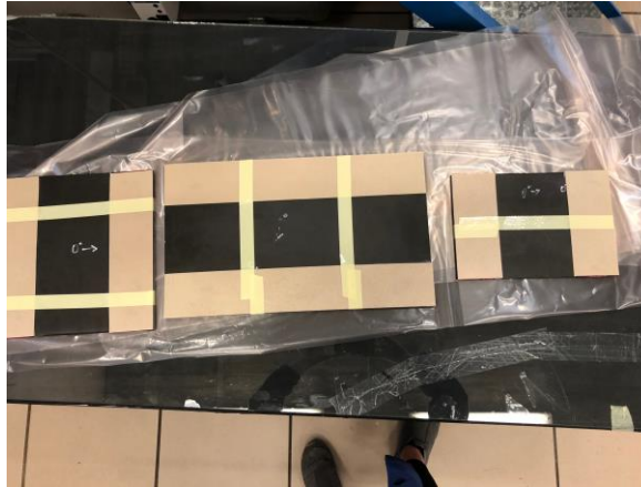
Figura 2.7.- Proceso de unión taco-panel.
