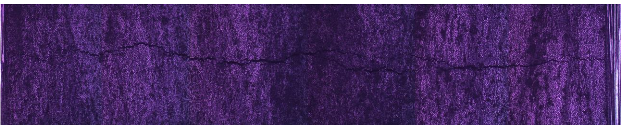
Figura 4.31.- Fotocomposición de la probeta 16-21, grieta transversal en el espesor de 90°.
