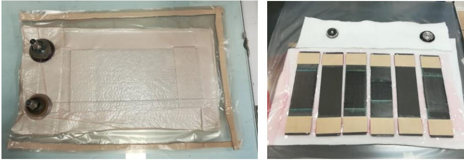
Figura 6-3. Bolsa de vacío del panel de probetas tipo G. Bolsa de vacío de los paneles de probetas tipo A, B, C, D, E y F.
