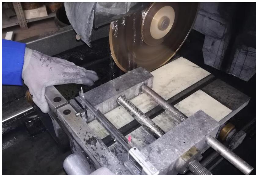
Figura 6-6. Corte de paneles.
