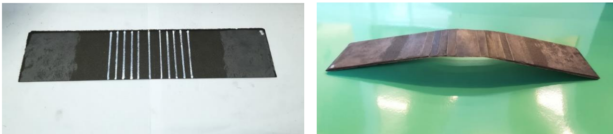
Figura 3-17. Panel de probetas tipo D antes y después del resanado.
