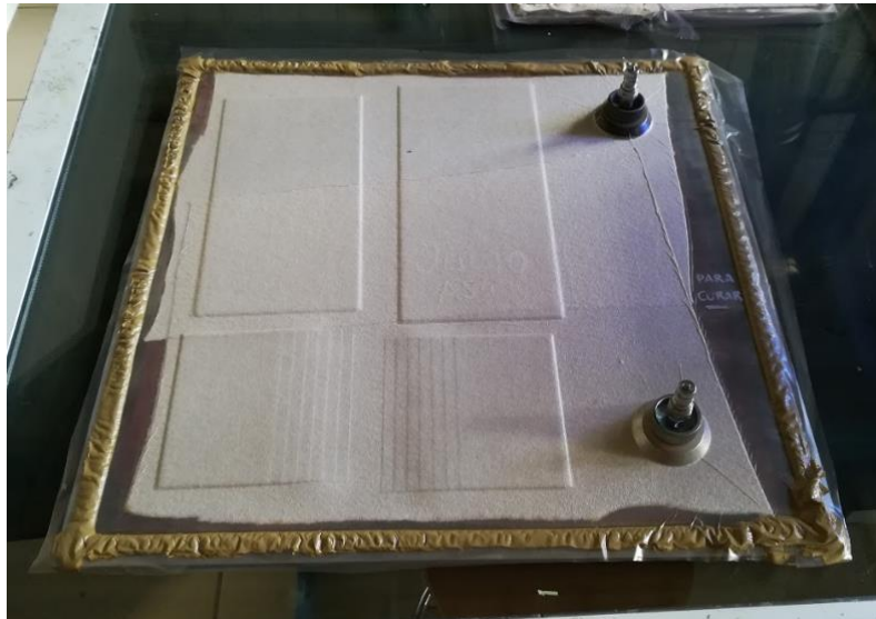
Figura 3-9. Curado paneles 1, 2 y 3
