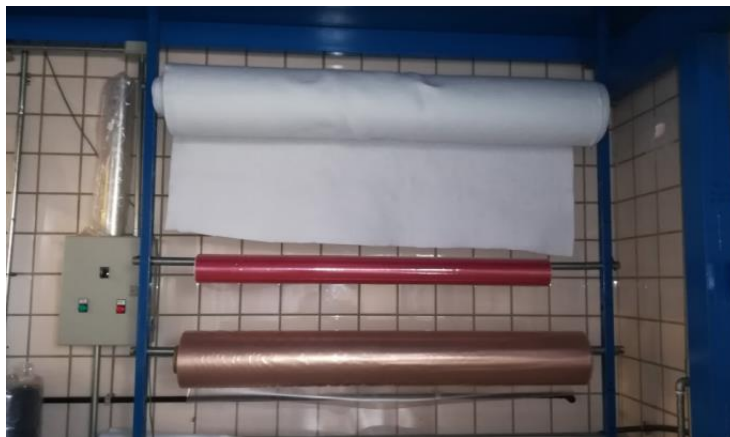
Figura 3-3. Arriba el Airweave, en el medio el teflón y abajo la bolsa de vacío.
