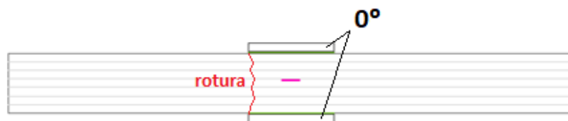
Figura 8-21. Representación de la rotura en la probeta Tipo C.
