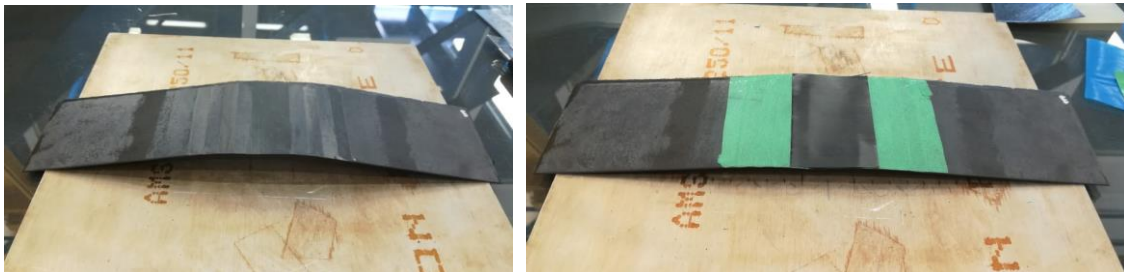
Figura 4-6. Unión del parche al panel D.
