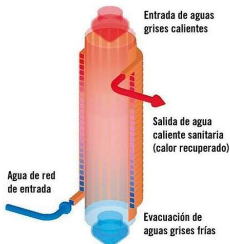
*Ilustración 9. Sistema de recuperación de calor en aguas grises (Pistonesi, 2010)*
