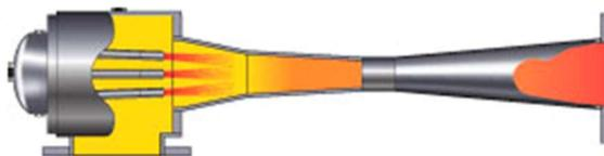
Ilustración 16. Termocompresor de boquilla múltiple
