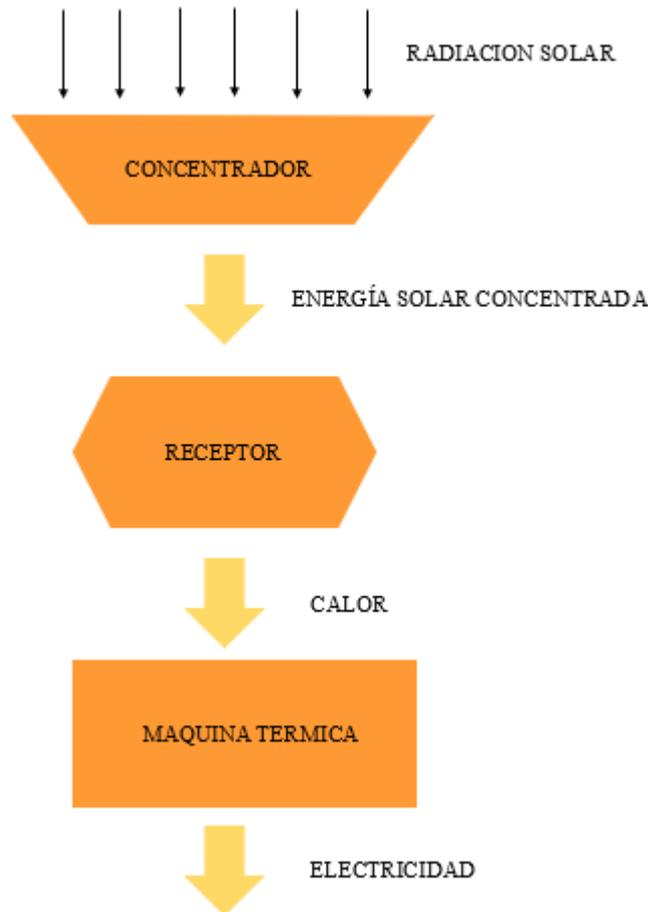
Figura 3. Esquema simplificado de un sistema de energía térmica de concentración. [3]
