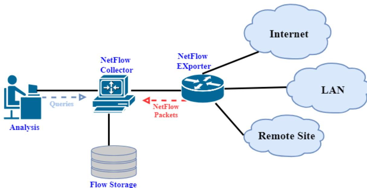
*Figura 1-2 Funcionamiento de Netflow*
