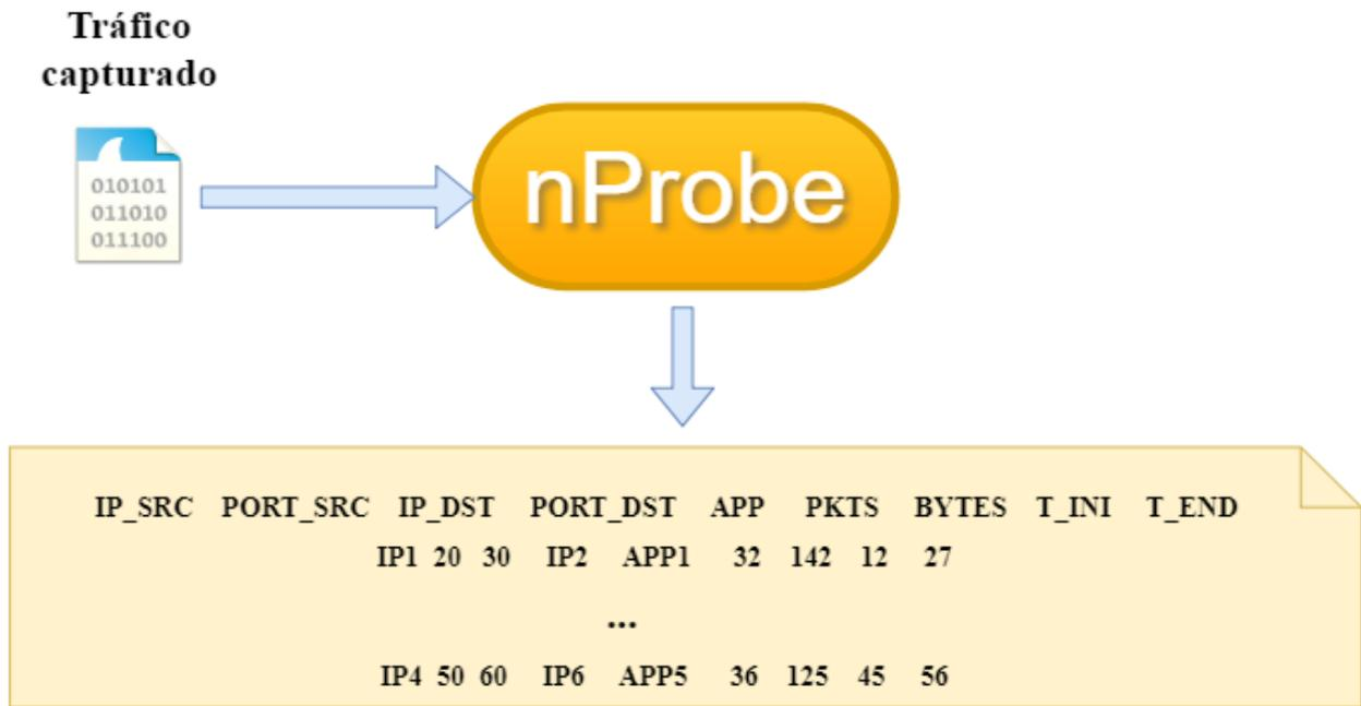
*Figura 2-20 Uso de nProbe.*
