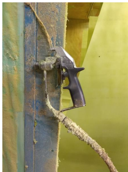
Figura 12. Pistola aerográfica de la empresa colaboradora empleada para la imprimación del enmascarante.
