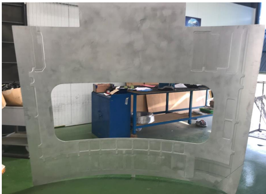
Figura 18. Resultado final de dos piezas tras un tratamiento de fresado químico
