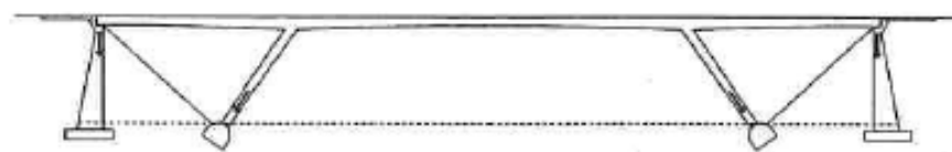
Figura 1.10 Strut frame bridge o puente pòrtico de pilas inclinadas con vanos de compensación.
