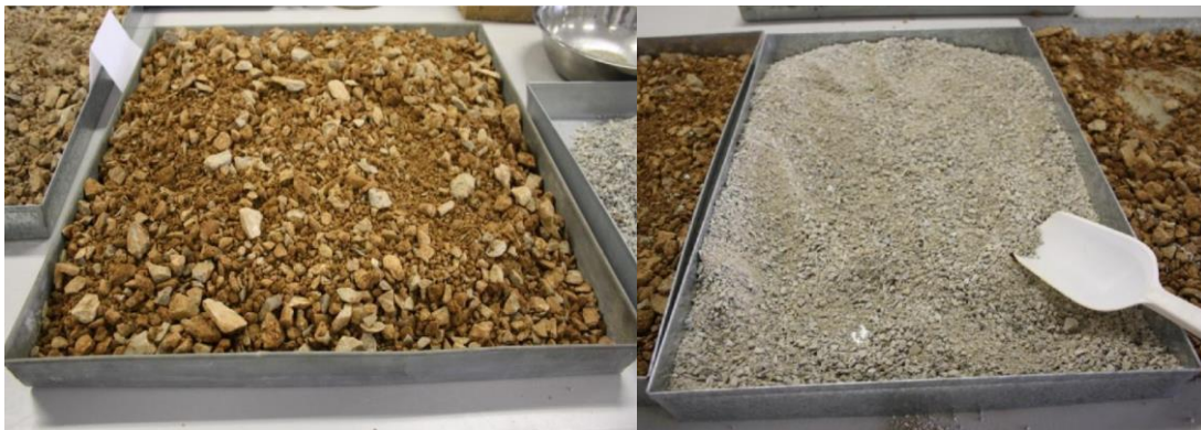
Ilustración 6: Zahorra artificial ZA-25, izquierda
