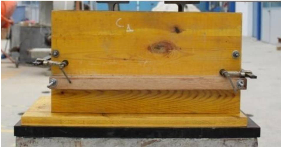
Ilustración 24: Molde para probetas de 100x450x100mm
