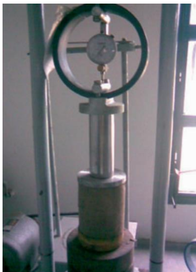
Ilustración 90: Ensayo de compresión simple, Bloques de tierra comprimida (BTC) sin adición de cemento [2]
