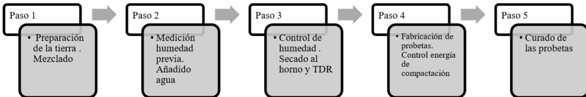
Ilustración 18: Proceso de fabricación de las probetas, [1].
