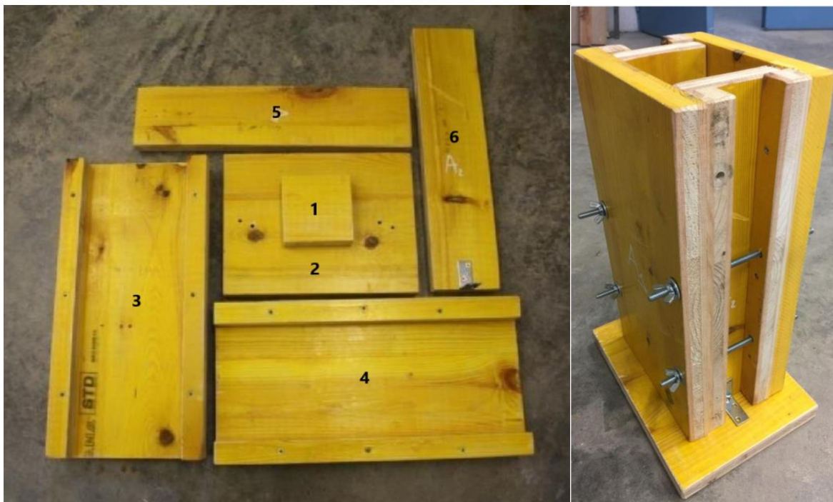
Ilustración 23: Molde para probetas de 100x200x100 mm
