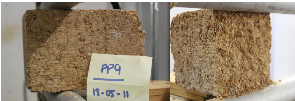
Ilustración 49: Ensayo brasileño, tracción en la dirección de compactación
