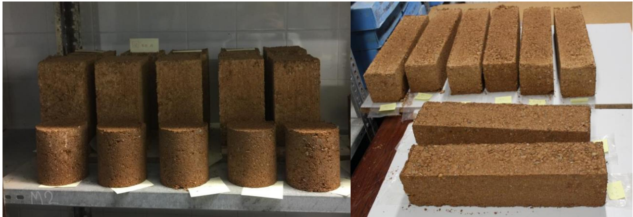
Ilustración 39: Probetas prismáticas 100 \times 100 \times 200 \text{ mm} y probetas cilíndricas (izquierda) y probetas prismáticas 100 \times 450 \times 100 \text{ mm} (derecha)
