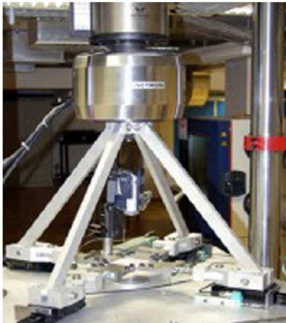
Figura 1.28. Mecanismo accesorio para ensayos biaxiales (Fraunhofer 2005).
