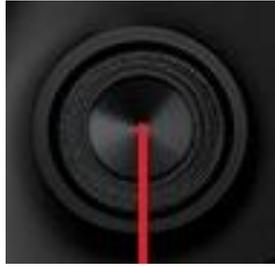
El joystick nos da un punto dentro de un plano cartesiano, con valores  $x \in [-1,1]$  e  $y \in [-1,1]$ . A partir de estas coordenadas, se pasa a polares para calcular el ángulo que forma con la posición cero la articulación. Si el joystick esta centrado  $(0,0)$ , no introduce una nueva referencia.
