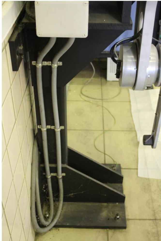
Figura 1-2. Estructura de soporte: fijaciones a pared y suelo
