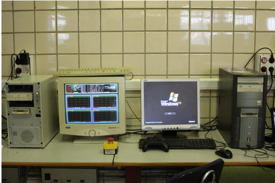
Figura 1-15. 'Puesto de Mando': PC *Host* (Derecha), PC *Target* (Izquierda), junto a seta de emergencia y mando para control manual del brazo.
