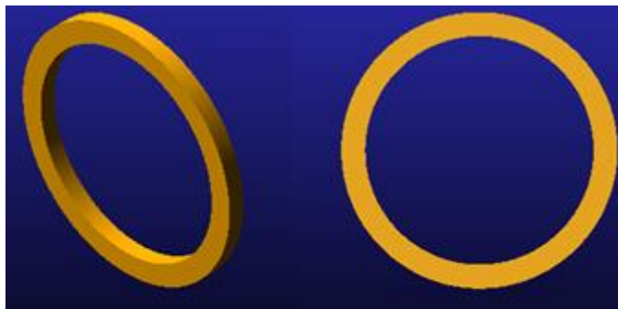
Figura 6-5: Modelo del anillo exterior de la rueda libre
