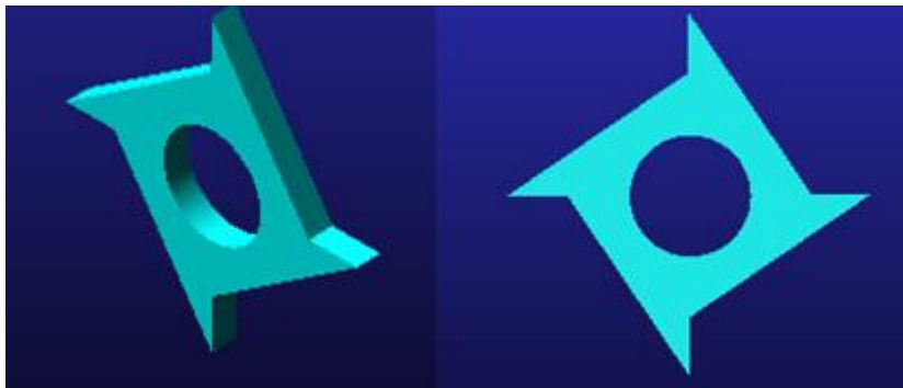
Figura 6-4: Modelo del anillo interior de la rueda libre
