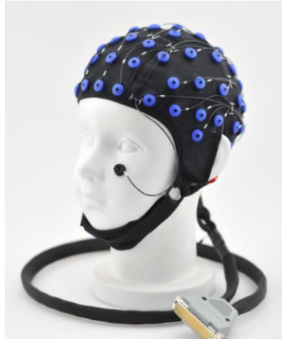
Figura 3-4. Electrodo superficial en caso de malla
