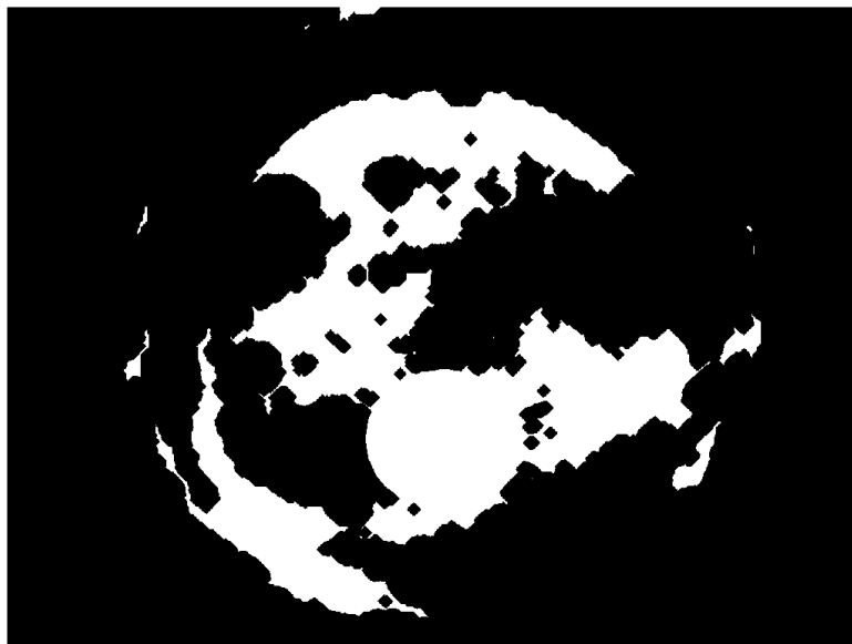
Figura 3.6 Erosión con elemento estructurador en forma de diamante.
