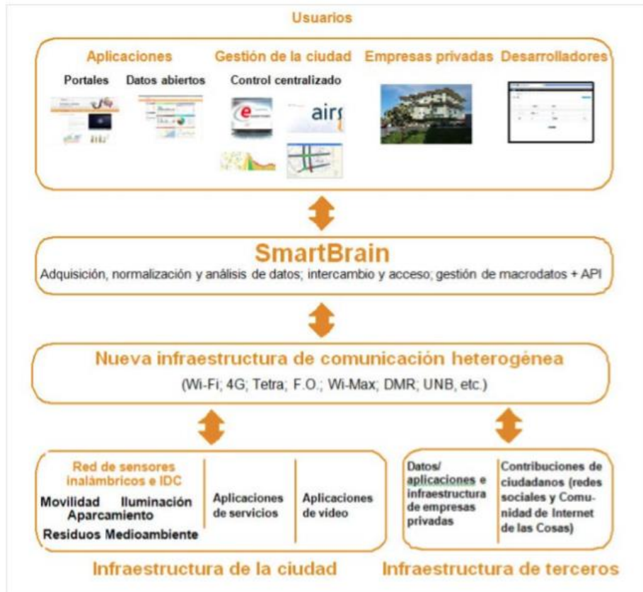
Figura 4-15. Esquema modular de SmartBrain [86]
