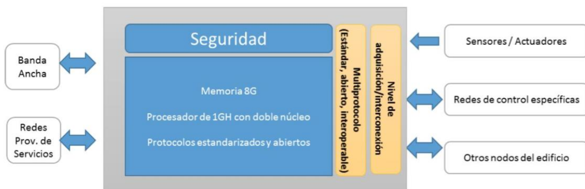
Figura 5-7. Estructura Nodo IoT de edificio [97]
