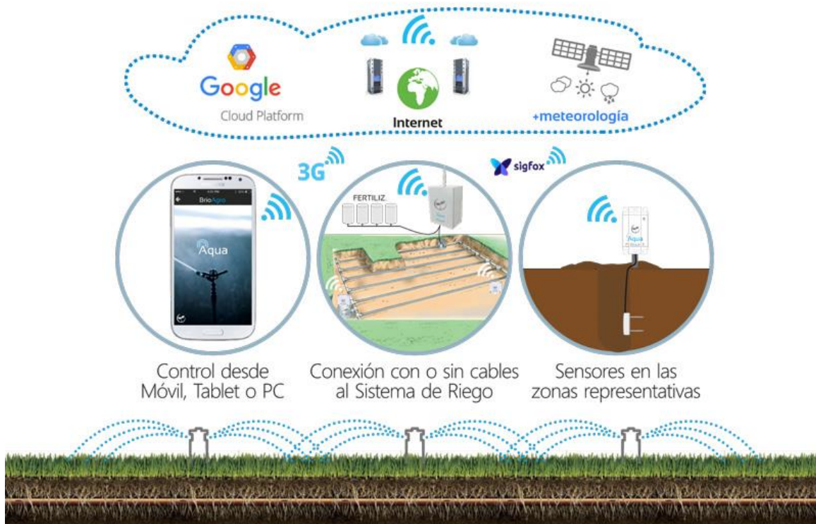
Figura 4-8. Esquema de funcionamiento SmartAqua [55]
