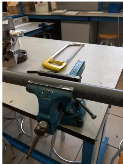
Figura 6-1. Agarre mediante mordaza del tubo de PVC para situarlo en su posición de corte.
