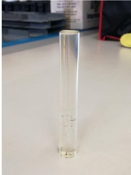
Figura 5-3. Apariencia del cilindro de resina tras el proceso de pulido.
