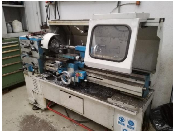
Figura 6-16. Torno manual Pinacho S-90/180.
