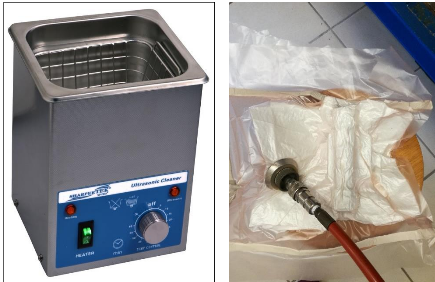
Figura 5-7. Posibles métodos para la eliminación de burbujas de la resina.
