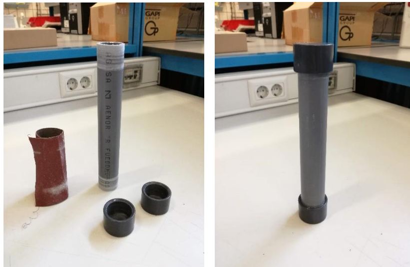
Figura 6-4. Lijado de los extremos del tubo y posterior pegado de los tapones de PVC.
