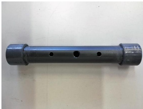
Figura 6-8. Aspecto definitivo del molde desechable de PVC.
