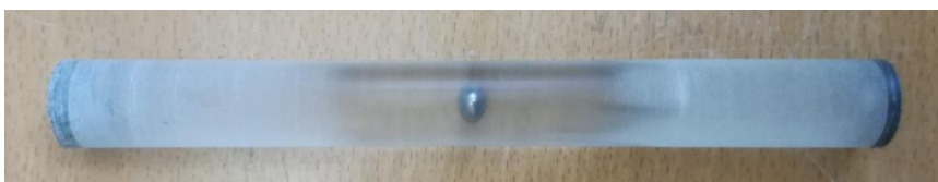
Figura 6-19. Aspecto definitivo de la probeta tras el proceso de pulido.
