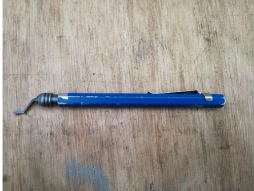
Figura 6-7. Desbarbador empleado para el perfeccionamiento del contorno del taladro.
