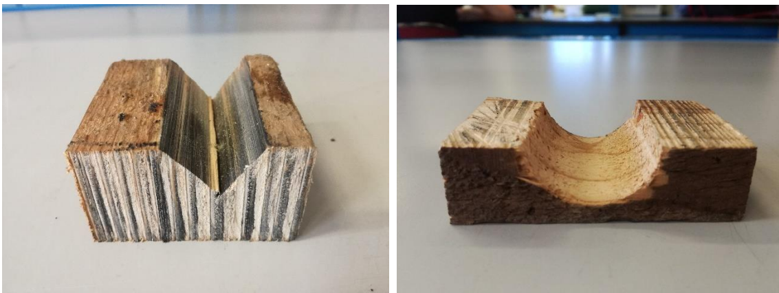
Figura 5-9. Comparativa entre los dos soportes de madera empleados a lo largo de las pruebas.
