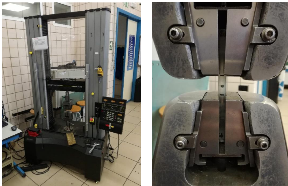
Figura 7-5. Máquina universal INSTRON 4482 y detalle del agarre de la probeta.
