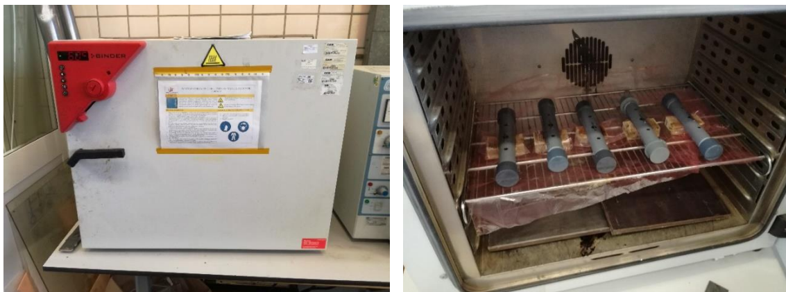
Figura 6-15. Horno de laboratorio empleado para el curado de la resina.
