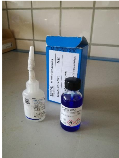
Figura 6-9. Pegamento de contacto para bandas extensométricas.
