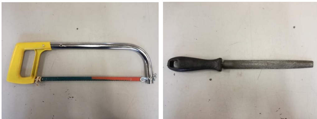
Figura 6-2. Sierra para metal y lima empleadas.
