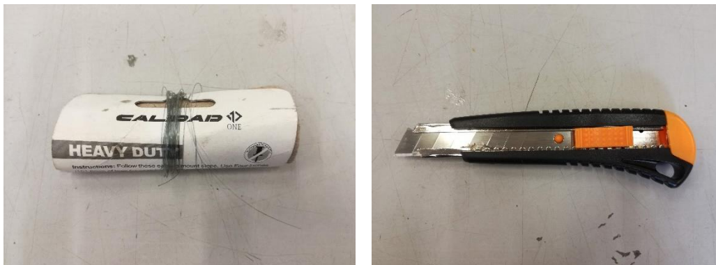
Figura 6-10. Hilo de pescar de 0.3 milímetros y cúter empleado para el corte.
