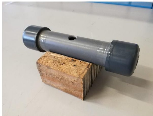
Figura 5-8. Conjunto molde-soporte en la posición de curado.
